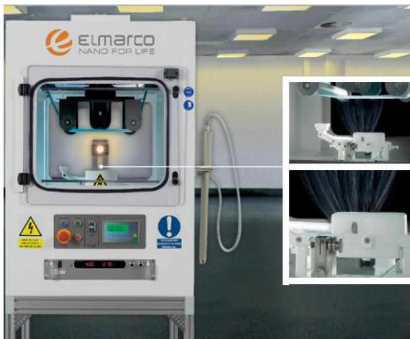
Figura 2 - Máquina de electrospinning NS LAB e visão ampliada da produção dos fios.
